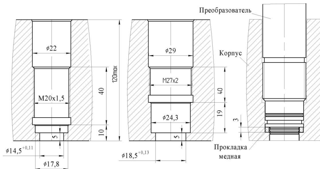
Рисунок 7 – Разметка монтажного гнезда и установка первичного преобразователя датчика МИДА-ДИ-12П-081-К
